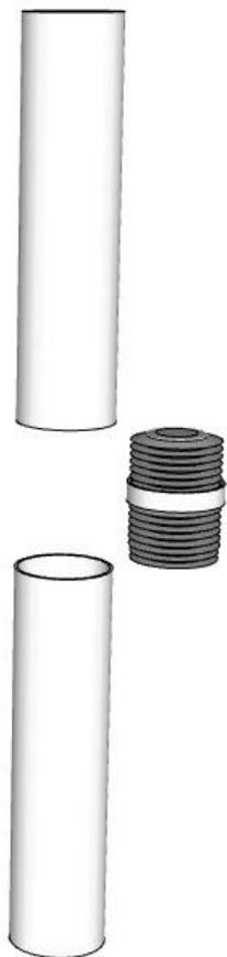
6 unidades de rosca macho por ambos lados una sección de aluminio vista para lograr continuidad en la unión.
